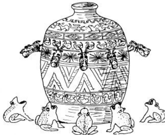
Abb.8: Der Erdbebenanzeiger des Chinesen Chang Heng, 132 n.Chr. Die Zeichnung ist nach einer überlieferten Beschreibung angefertigt.
