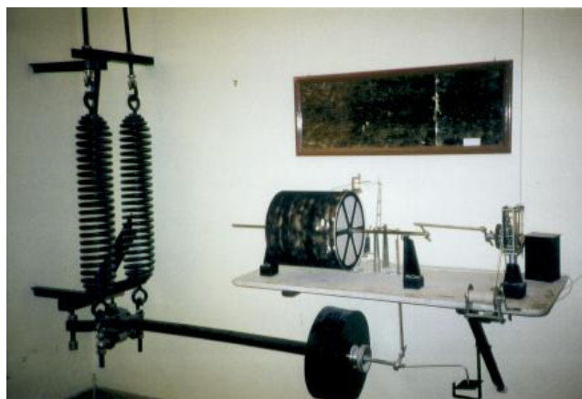
Abb.14: Der Vertikalseismograph von Cancani im Vesuvobservatorium, 1902.
