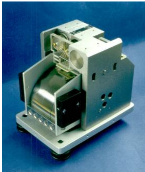
Abb.19: Das Zürcher Blattfederseismometer, eine kompaktere Version des in Abb.5 skizzierten Blattfederpendels. Die beiden schwarzen Klötze links vorn und hinten sind die seismische Masse, dazwischen die gebogene Blattfeder. Oben sind in Bohrungen zwei Tauchspulensysteme für die Krafrückführung und der berührungsfreie Wegaufnehmer untergebracht. Unter der Feder verborgen ist ein fernbedienbares Tariergewicht.
