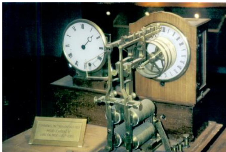
Abb.10: Mit diesem Gerät hielt Palmieri die Zeit des Kontaktschlusses fest.
